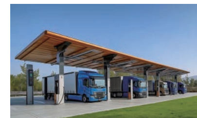
大型トラックのバッテリー交換ステーション
